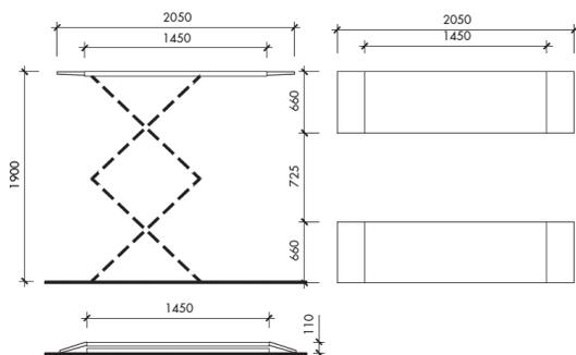
Plan d'adéquation des sols : béton type C20/25 (DIN : 1045 : 2001-07), séchage ≥ 28 jours, épaisseur ≥ 160 mm, écart de niveau de 5 mm maxi
