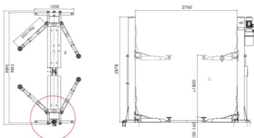
Plan d'adéquation des sols : épaisseur dalle  $\geq$  200 mm, résistance béton  $\geq$  30 N/mm<sup>2</sup>, écart de niveau de 10 mm maxi.
