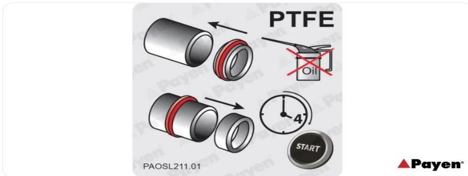
Bague d'étanchéité, différentiel
