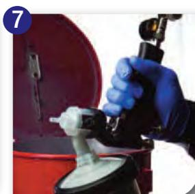
7 Après utilisation, déconnecter le pistolet de l'air comprimé, puis pistolet à l'envers, gâchette à fond, séparer le pistolet du godet PPS
