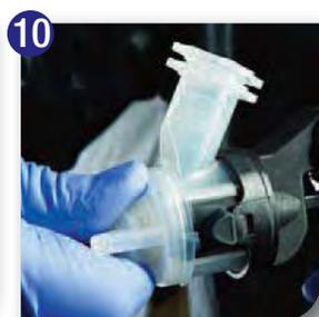
10 Replacer la même buse de pulvérisation sur le pistolet (ou la changer si nécessaire).
