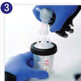
3 Clipser le godet et sa poche PPS remplie d'apprêt et branchez le pistolet sur l'air comprimé.
