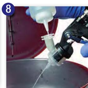
8 Nettoyez la buse de pulvérisation avec le minimum de solvant jusqu'à l'élimination totale des résidus d'apprêt.
